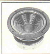
WSP 13 S: Kompakt-Tiefertonlautsprecher in HiFi-Qualität mit Polypropylen-Membran, große Partialschwingungsfreiheit, sehr breitbandig einsetzbar, 45/55 W, 30-6000 Hz, 131 mm Ø
